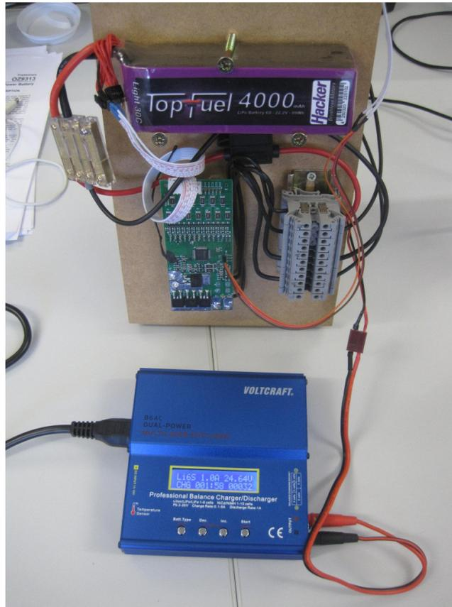
Ladegerät (VOLT CRAFT B6AC) muss mit dem bereitgestellten Ladestecker am Versuchsaufbau verbunden werden
