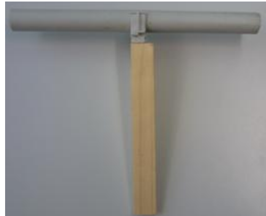
Abbildung 5: Holzkeil mit Rohrschelle und Elektroinstallationsrohr
